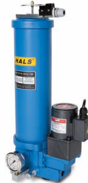
HEP 전동펌프는 소형의 제품으로 설치공간의 제약이 적고, 취급 설치가 간단하다. 감속 MOTOR를 통한 피스톤 운전방식으로 정확한 윤활급유가 가능하고, 최대 250kg/cm<sup>2</sup> 토출압력으로 비교적 원거리 및 많은 급유개소의 시스템에 활용이 된다. HEP 펌프도 절환밸브의 부착여부를 선택할 수 있으며, 별도의 전기제어반 부착도 가능하다.
