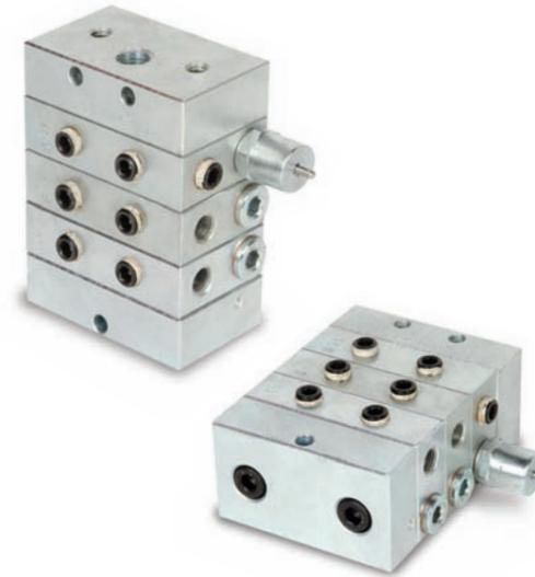
M형 순차식 분배변은 SINGLE LINE 그리스 시스템에 사용되는 분배변으로 각 윤활개소에 일정량의 그리스를 순차적으로 급유하는 분배변이다. 급유개소에 따라 BLOCK수를 증감할 수 있고 한 분배변의 모든 토출구로 그리스가 분배되었을때 측면의 지시봉이 1회 전후진 하므로 분배변의 작동유무를 확인할 수 있다. 또한 이 지시봉에LIMIT SWITCH를 부착하여 메인 장치에서도 분배변의 작동을 모니터링 할 수 있다.
