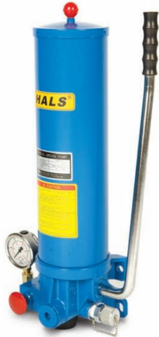
HM 펌프는 소형 수동 그리스 펌프로서 급유 빈도가 자동펌프에 비하여 적은 경우에 사용되며, 윤활급유소가 비교적 적은 시스템에 적용된다. 최고 토출압력은 토출량에 따라 100kg/cm<sup>2</sup>와 210kg/cm<sup>2</sup> 두가지로 나누어지며, 탱크의 용량도 2Liter와 4Liter로 구분된다. 토출부 블록의 교체로 SINGLE LINE과 TWO LINE 적용시 절환변 부착이 가능하다. 작동방법이 간단하여 고장이 적고, 유지보수가 용이하다.
